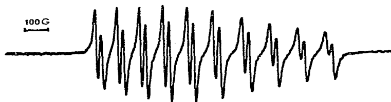
Fig. 1. Spectre RPE du complexe \text{Cp}_2\text{NbF}(\text{hfbH}) (III) (solvant: toluène, température \sim 300 K). Les structures hyperfine et superhyperfine proviennent de l'interaction de l'électron célibataire avec les noyaux ^{93}\text{Nb} ( I = 9/2 ) et ^{19}\text{F} ( I = 1/2 ).
